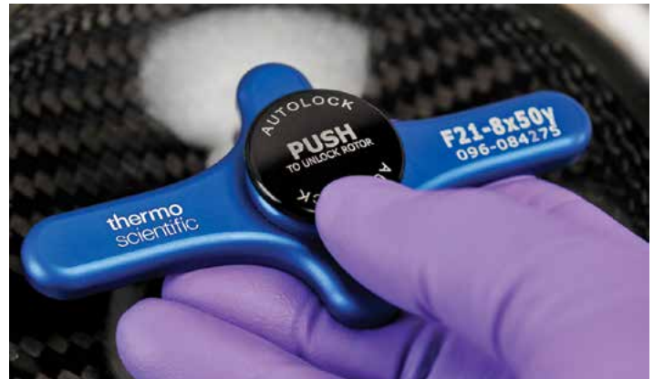
Sicheres Einsetzen und Entnehmen des Rotors in nur drei Sekunden
