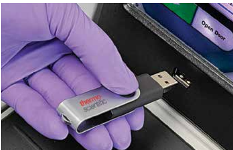
USB-Anschluss zum Herunterladen von Laufdaten
